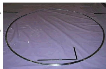
福島第一原子力発電所 乾式貯蔵キャスクの二次蓋ガスケット
